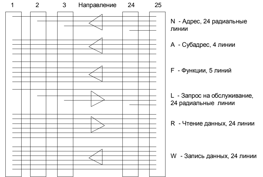
Рис. 4.3. Основные шины горизонтальной магистрали
