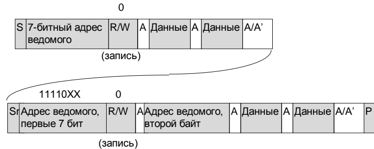
Рис. 6.18. Комбинированный формат. Ведущий передает данные двум ведомым устройствам: одному с 7-битным адресом, другому с 10-битным адресом
