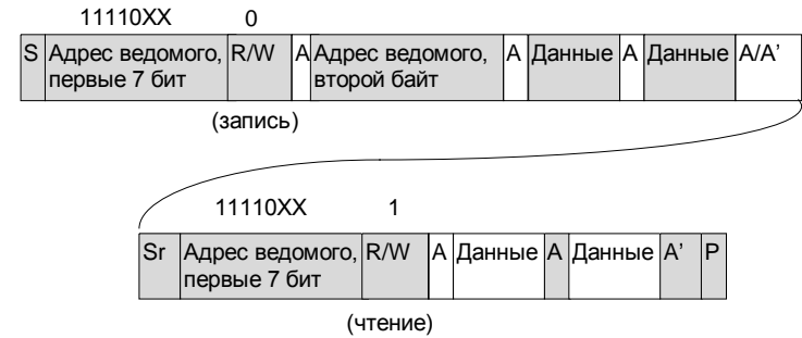
Рис. 6.16. Комбинированный формат. Ведущий адресует ведомое устройство с 10-битным адресом, а затем передает данные ему и читает данные от него
