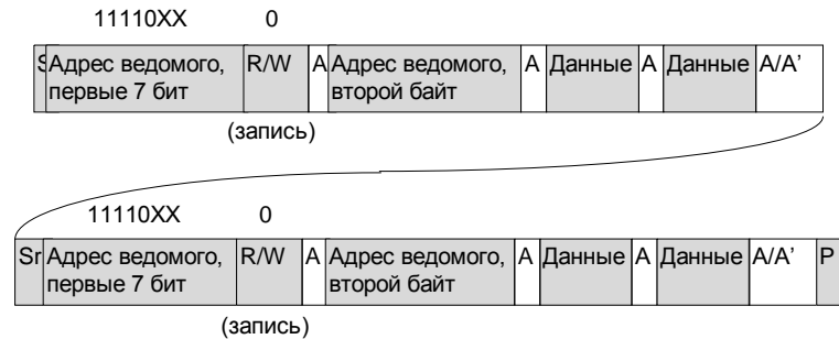
Рис. 6.17. Комбинированный формат. Ведущий передает данные двум ведомым устройствам с 10-битными адресами
