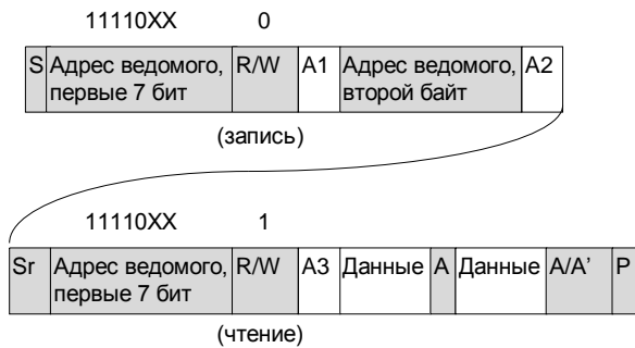
Рис. 6.15. Ведущий приемник адресует ведомый передатчик с 10-битным адресом
