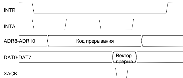
Рис. 6.5. Векторное прерывание с участием шины
