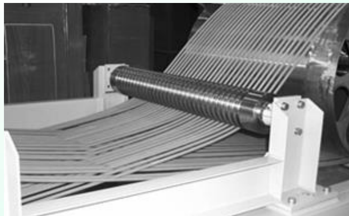
Обработка изоляции кабелей на ускорителе серии ЭЛВ (ИЯФ СО РАН)
